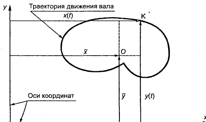
О — среднее положение траектории; К — мгновенное положение центра вала; \bar{x} , \bar{y} — среднее значение перемещения вала; x(t) , y(t) — изменяющиеся со временем значения перемещения вала
